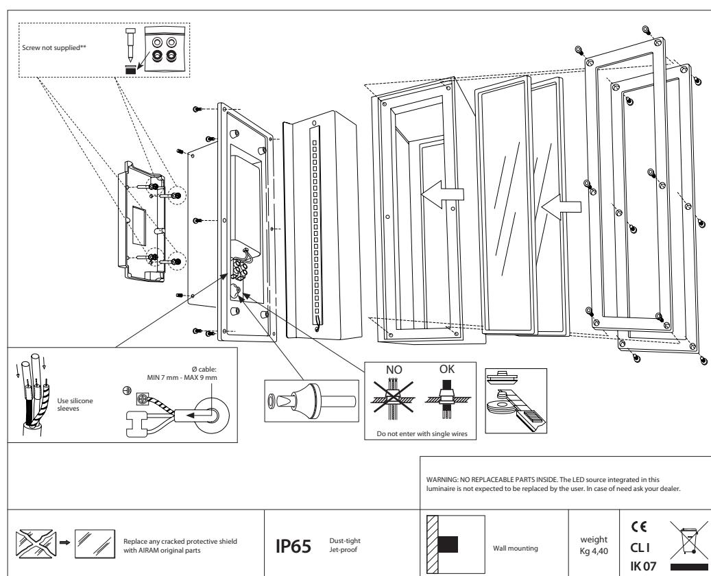
Valaisimen saa asentaa vain sähköalan ammatilainen. Käytä ainoastaan syöttöjänitettä ja taajuutta joka on merkity valaisimeen/liitäntälaitteeseen. Kytke virta pois päältä ennen asennusta tai huoltoa. Tämä asennusohje on säilytettävä ja sen on oltava käytössä asennuksessa ja huollossa. Tämän valaisimen valonlähde ei ole vaihdettavissa. Kun valonlähde rikkoutuu, koko valaisin on poistettava käytöstä.
