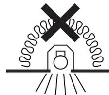
Valaisinta ei saa asentaa suoraan eristemateriaaliin. Denna armatur är inte avsedd för att täckas med värmeisolerande material. The luminaire is not suitable for covering with thermally insulated material.
