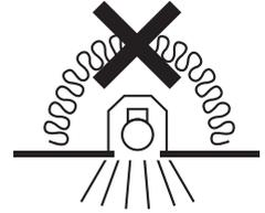
Valaisinta ei saa asentaa suoraan eristemateriaaliin. Denna armatur är inte avsedd för att täckas med värmeisolerande material. The luminaire is not suitable for covering with thermally insulated material.
