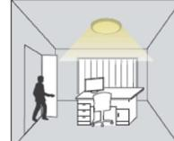
Jos valaistusvoimakkuus on < 10 luksia ja havaitaan liikettä, paneeli käynnisty. / Panelen tänds om < 10 lux och rörelse detekteras. / Kui < 10 luksi ja tuvastatakse liikumine, lülitub valgusti sisse. / If < 10 lux and movement is detected, panel does not go on.
