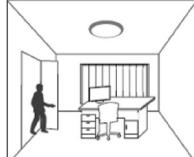
Jos valaistusvoimakkuus on > 10 luksia ja havaitaan liikettä, paneeli ei käynnisty. / Panelen tänds inte om > 10 lux och rörelse detekteras. / Kui > 10 luksi ja tuvastatakse liikumine, ei lülitu valgusti sisse. / If > 10 lux and movement is detected, panel does not go on.
